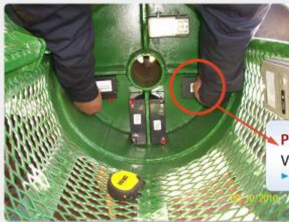
鳳凰號上安裝VDSL2網路轉換器(VC-201A)
